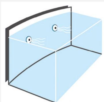
Les jets hydromassants envoient de l'eau sous pression avec des bulles d'air.
